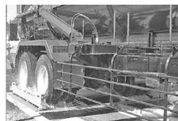
ダブルタイヤを高圧スプレー噴射水で洗浄
