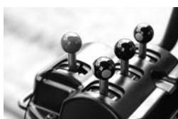
複雑なオペレーションが要求されるグレーダの操縦を自動制御でアシストします。マシンコントロール用のスイッチは作業機レバーに内蔵されているため、操作感を損なわずに作業が行えます。設計データに対して、ブレードリフトを自動制御するだけではなく、新たにブレードシフトの自動制御も行えるようになりました。またパワーチルトにも対応しており、ブレードの切削角を変更してもリフトとシフトの自動制御が可能です。
