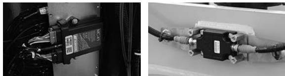
マシンコントロールショベルで採用しているMC-X1とTS-i4 (IMU) を搭載。
