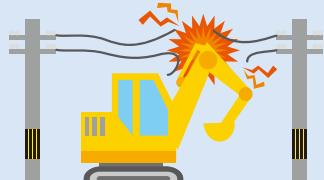
油圧ショベルを操作中、誤ってブームが電線に接触して切断した。
